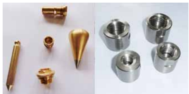
Messing-Senklote und bearbeitete Gewinde
