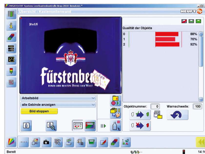
Etikettenreste und weitere vom Standard abweichende Objekte sind auf der hochauflösenden Aufnahme perfekt erkennbar. Das System markiert sie selbständig und gibt eine erste Einschätzung darüber ab, ob und mit welcher Wahrscheinlichkeit es sich dabei um tatsächliche Fehler handelt. Die endgültige Entscheidung liegt dann beim Bediener.
