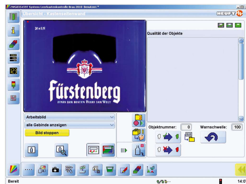
Auf der grafischen Benutzeroberfläche HEUFT PILOT am Bedienterminal des HEUFT LGX wird eine Gesamtansicht angezeigt. Sie bildet die komplette Seitenwand des Leerkastens ab, ohne Bildfläche zu verschwenden.
